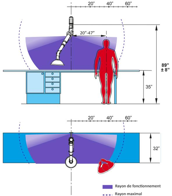
Afin d'optimiser l'efficacité de l'aspiration, il est recommandé de respecter les hauteurs de montage et les déplacements latéraux suivants par rapport au poste de travail.
