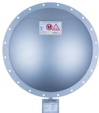
L'événement circulaire de type GT est spécifiquement conçu pour les applications nécessitant une Pstat élevée. Les applications spéciales avec une pression d'exploitation élevée requièrent des événements d'explosion avec des pressions statiques d'ouverture qui dépassent la valeur courante de 0,1 barg.
