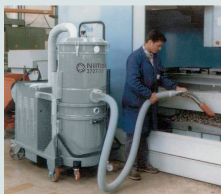
Industrie mécanique : élimination de copeaux sur les machines-outils
